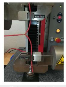
Test setup longitudinal tension
